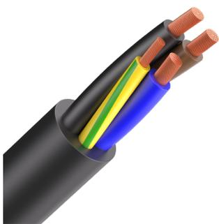
Кабель огнестойкий, гибкий, силовой, с медными жилами, с изоляцией и оболочкой из поливинилхлоридного пластика пониженной пожарной опасности, не распространяющий горение, с низким дымо- и газовыделением
