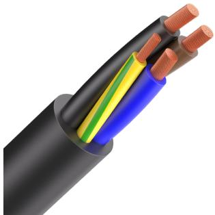
Кабель гибкий, силовой, с медными жилами, с изоляцией и оболочкой из поливинилхлоридного пластика пониженной пожарной опасности в тропическом исполнении, не распространяющий горение, с низким дымо- и газовыделением
