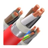
Одна или три токопроводящие жилы, изоляция из этиленпропиленовой резины, наружная оболочка из поливинилхлоридного пластиката.
