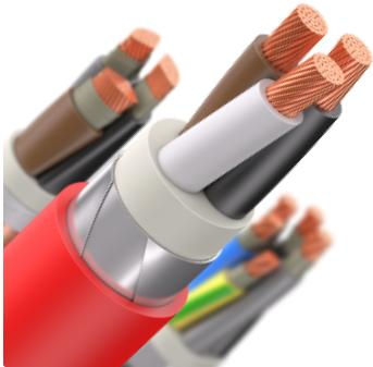
Одна или три токопроводящие жилы, изоляция из этиленпропиленовой резины, наружная оболочка из поливинилхлоридного пластика пониженной пожарной опасности с низким дымо- и газовыделением.
