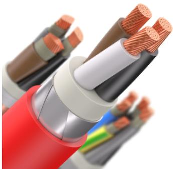
Три токопроводящие жилы, изоляция из этиленпропиленовой резины, броня из металлических лент, наружная оболочка из полимерной композиции, не содержащей галогенов.
