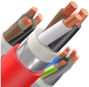
Три токопроводящие жилы, изоляция из этиленпропиленовой резины, броня из металлических лент, наружная оболочка из полимерной композиции, не содержащей галогенов.
