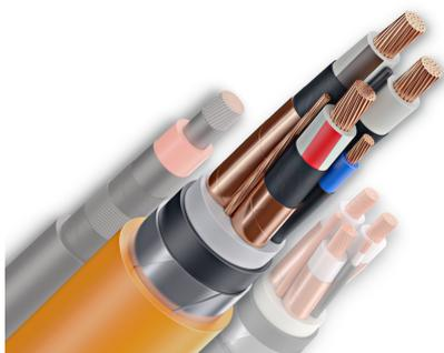
Изоляция из этиленпропиленовой резины, с медным экраном, броня из стальных оцинкованных лент, наружная оболочка из поливинилхлоридного пластика пониженной горючести.
