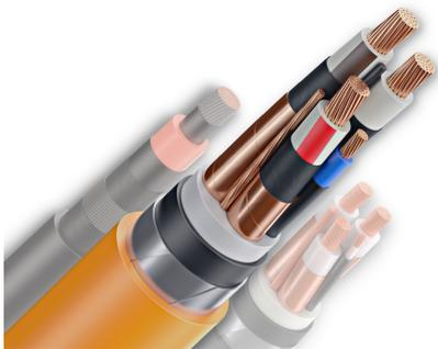
Изоляция и наружная оболочка из поливинилхлоридного пластика пониженной пожарной опасности, с медным экраном по основным жилам, броня из стальных оцинкованных лент.
