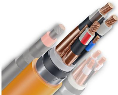
Изоляция из поливинилхлоридного пластика, наружная оболочка из поливинилхлоридного пластика пониженной горючести, с медным экраном по основным жилам, с водоблокирующими элементами, броня из стальных круглых оцинкованных проволок.
