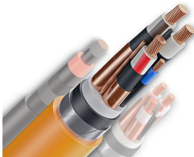
Изоляция и наружная оболочка из поливинилхлоридного пластика пониженной пожарной опасности, броня из стальных оцинкованных проволок в виде повива.
